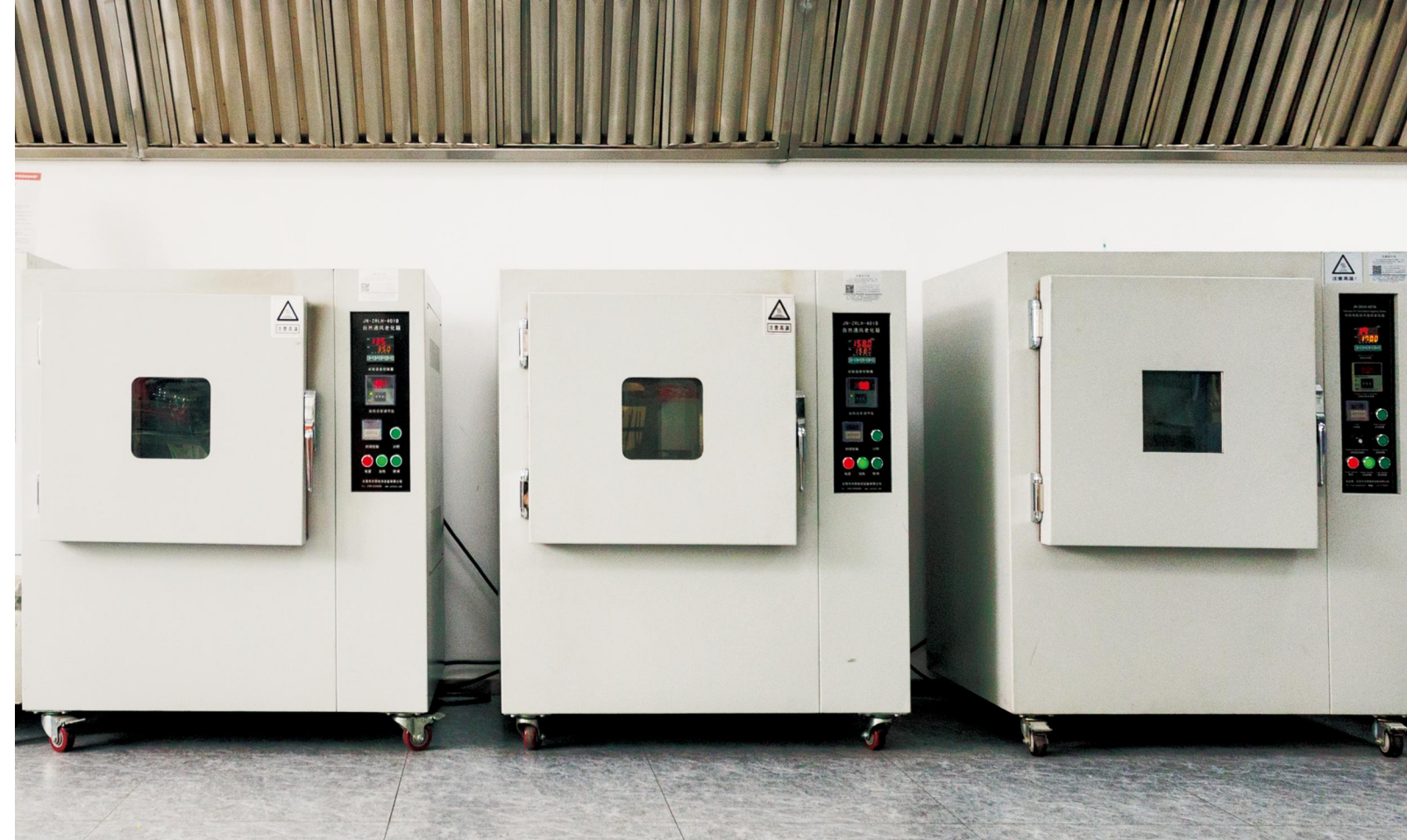
▲ 空气热老化试验箱
