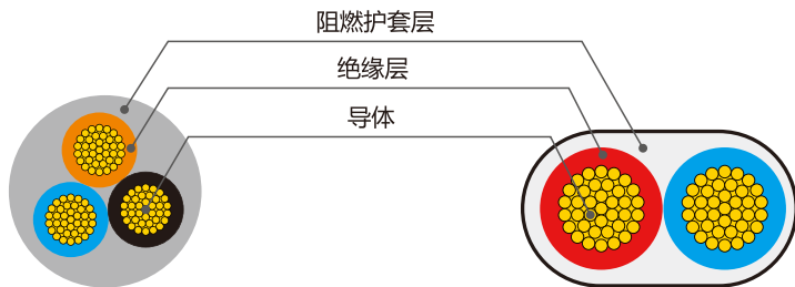
Z(A,B,C)-RVV及60227 IEC 53 ( RVV ) 结构示意图
