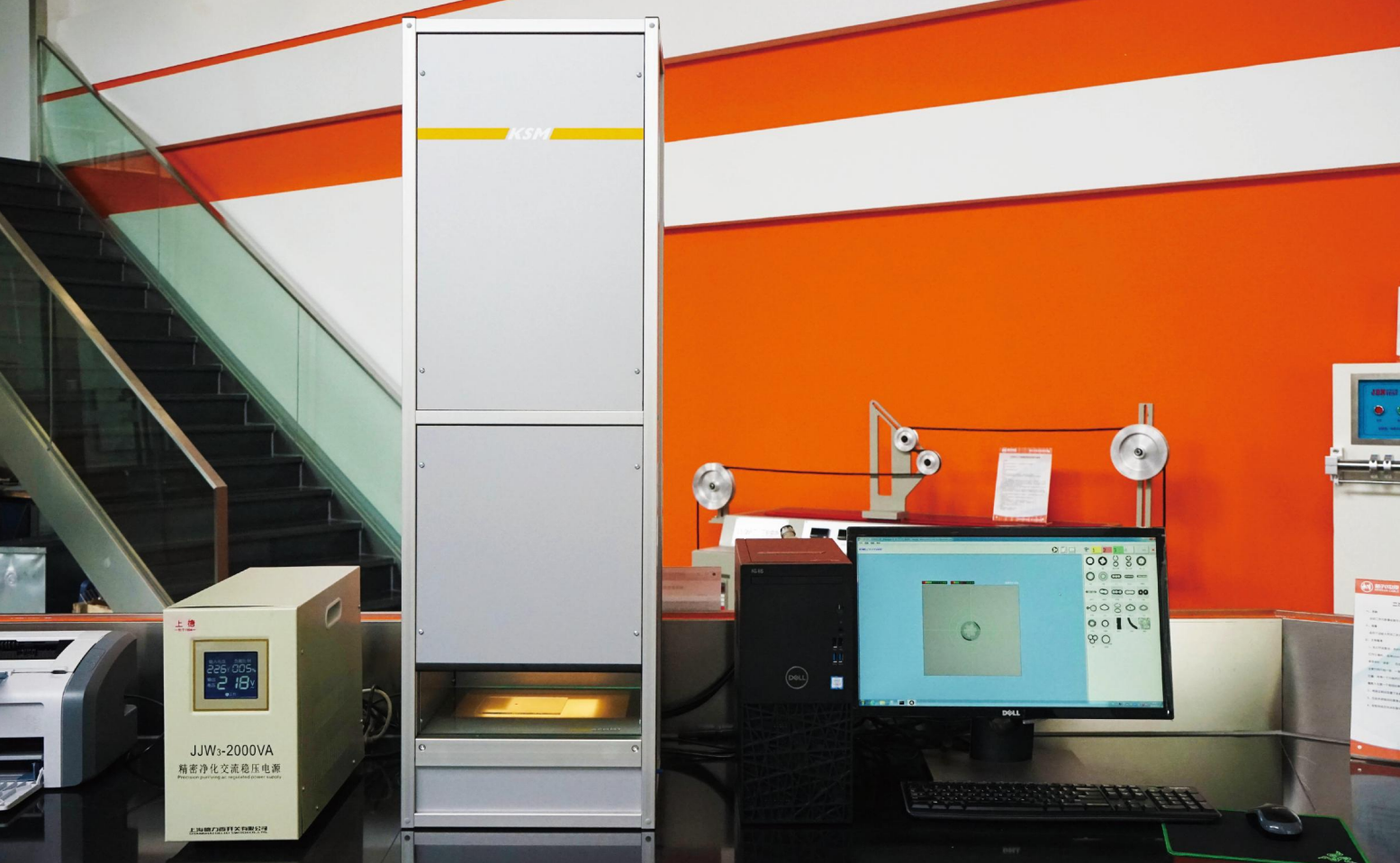
▲ KSM全自动电线电缆绝缘层测试仪
